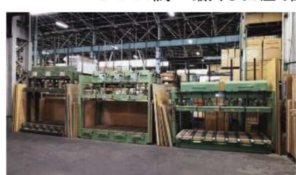
プレス機 最大 8 t の圧で部材加工が可能なプレスマシン。
