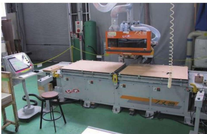
PNC 複合ボーリングマシン ボーリング機能から面取り・サイドカッターなど様々な加工ができるマルチ複合マシン
