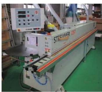
パーフェクトエッジバンディング ストリーマー 1057 ホルツヘル社の技術と経験・実績が作った高性能なエッジバンダー縁張機
