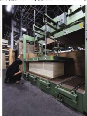
プレス機 最大 8 t の圧で部材加工が可能なプレスマシン。
