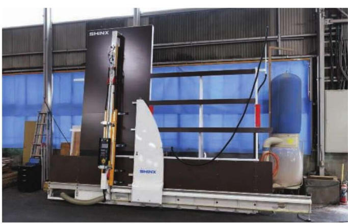
大型パネルソー 10 尺サイズの大きな板面を切断できるパネルソー。大型の天板やパーティションの生産が可能。
