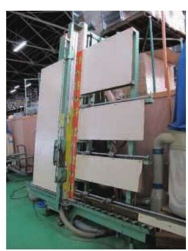
パネルソー 標準的な 8 尺サイズの板面を切断するパネルソー
