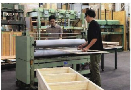
糊付機 木工に必要な糊付けを行う糊付機。
