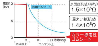
グラフは人体を絶縁板上で10kVに帯電させ、ゴムマット上に移動した際の人体帯電位の減衰状態を示したものです。汎用ゴムシートの場合には減衰に長時間を要しますが、このカラー導電性ゴムシートは瞬時に減衰するため、ICなどへの悪影響を防止できます。
