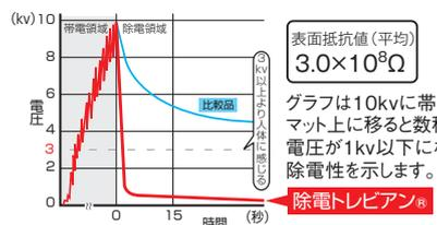
グラフは10kVに帯電した人がマット上に移ると数秒間で、電圧が1kV以下になる優れた除電性を示します。
