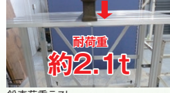
鉛直荷重テスト 公共試験所にて破壊テスト済み。(自社基準)
