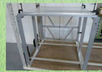
水平荷重テスト(自社基準) 公共試験所にて破壊テスト済み。
